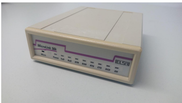
Abb. 13: Analoges Modem für Telefonleitungen mit 56 kbit/s maximaler Übertragungsrage
